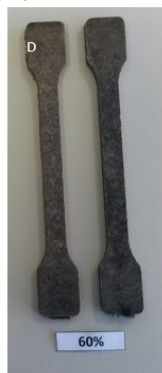
Figura 4 – Compósito com madeira antes e após exposição à radiação UV.
