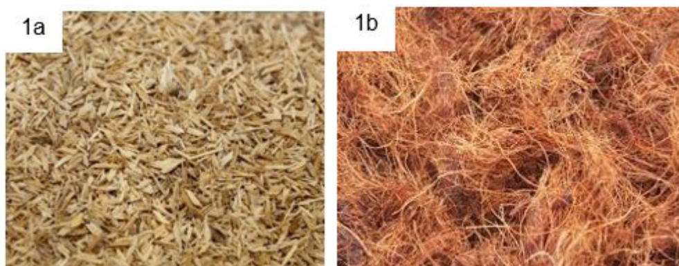
FIGURA 1 - RESÍDUOS NATURAIS UTILIZADOS PARA PRODUÇÃO DOS COMPÓSITOS. (A) RESÍDUO DE MADEIRA; (B) RESÍDUO DE COCO
