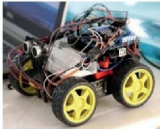
Figura 1- Robô montado a partir de um kit LEGO (A), e Robô montado com Arduino e módulos avulsos (B).
