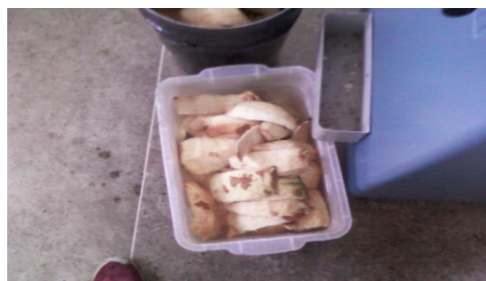
Figura 02 – Processo para obtenção da fibra de coco a partir do fruto verde; a) epicarpo extraído; b) mesocarpo exposto; c) mesocarpo cortado e armazenado em recipiente plástico contendo água. Fonte: Gabriel Abelha Carrijo Gonçalves, 2015.
