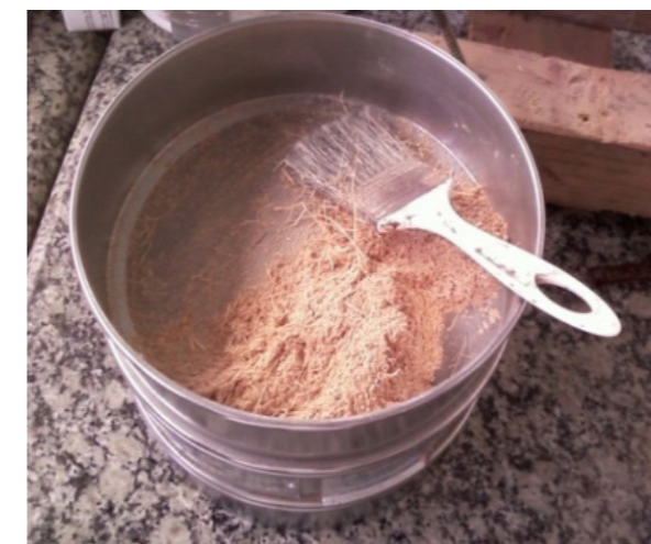
Figura 04 – Sequência de moagem do mesocarpo do coco verde: a) fibras longas do coco verde no moinho de bolas com 300 esferas; b) moinho de bolas em operação por 2h; c) tamisação do sólido particulado resultante da operação de micronização. Fonte: Gabriel Abelha Carrijo Gonçalves, 2015.
