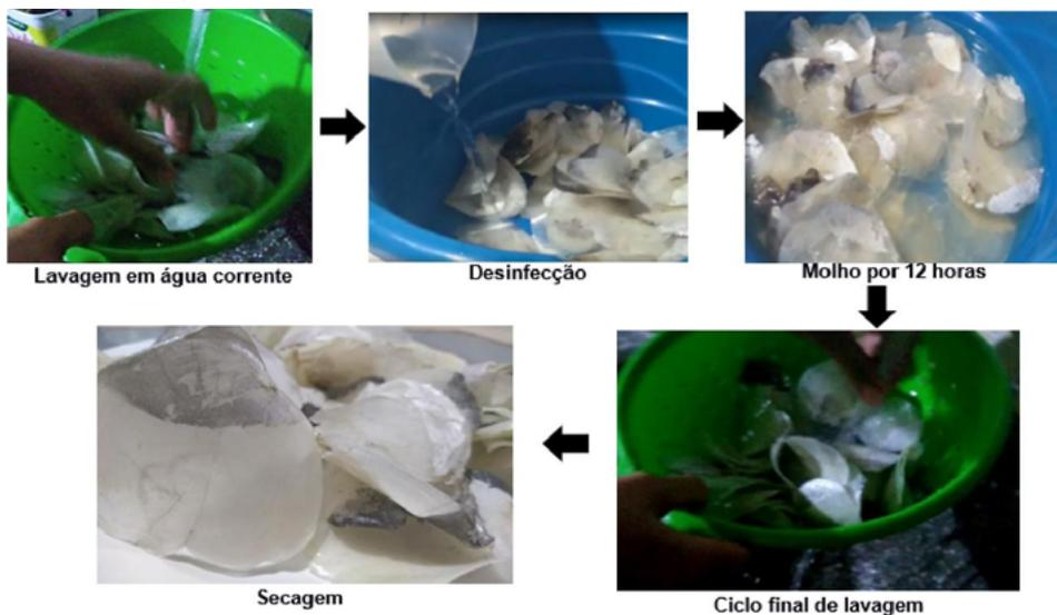
FIGURA 1 – PROCESSO DE BENEFICIAMENTO DAS ESCAMAS DE PEIXE PARA UTILIZAÇÃO NA FABRICAÇÃO DE BIJUTERIAS / FONTE: ELABORADA PELOS AUTORES.
