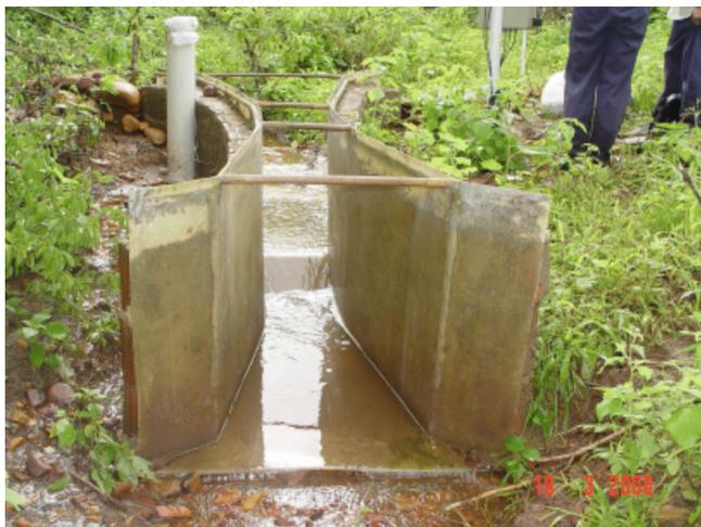
**Figura 3.** (A) Modelo do pluviógrafo e (B) calha Parshall instalados nas microbacias experimentais monitoradas em 19-3-2008
