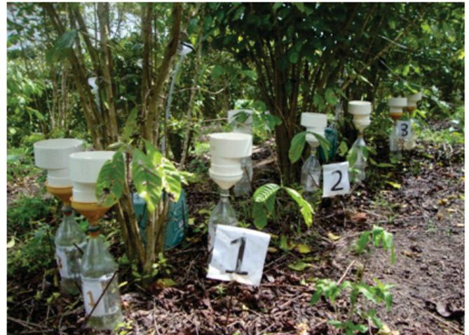
**Figura 2.** Interceptômetros utilizados para quantificação da precipitação interna
